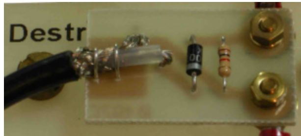
Diodo 1N4007 impiegato per commutare velocemente un dipolo ricevente per i 144 MHz. Il resistore da 1000 ohm chiude il circuito di polarizzazione.
