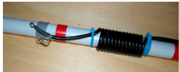
Fig. 9 - Un particolare del boom con il choke e l'alimentazione del dipolo.
