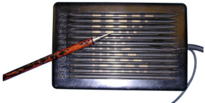
Tavoletta dell' Intelligence italiana usata per facilitare la trasmissione di numeri in codice Morse (Collezione Gen. Cremona, Colferro)
