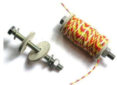
Il nucleo di un solenoide, con le flange, e un solenoide completato.
