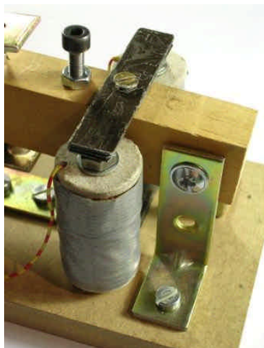
L'incernieratura della leva, realizzata con squadrette metalliche.
